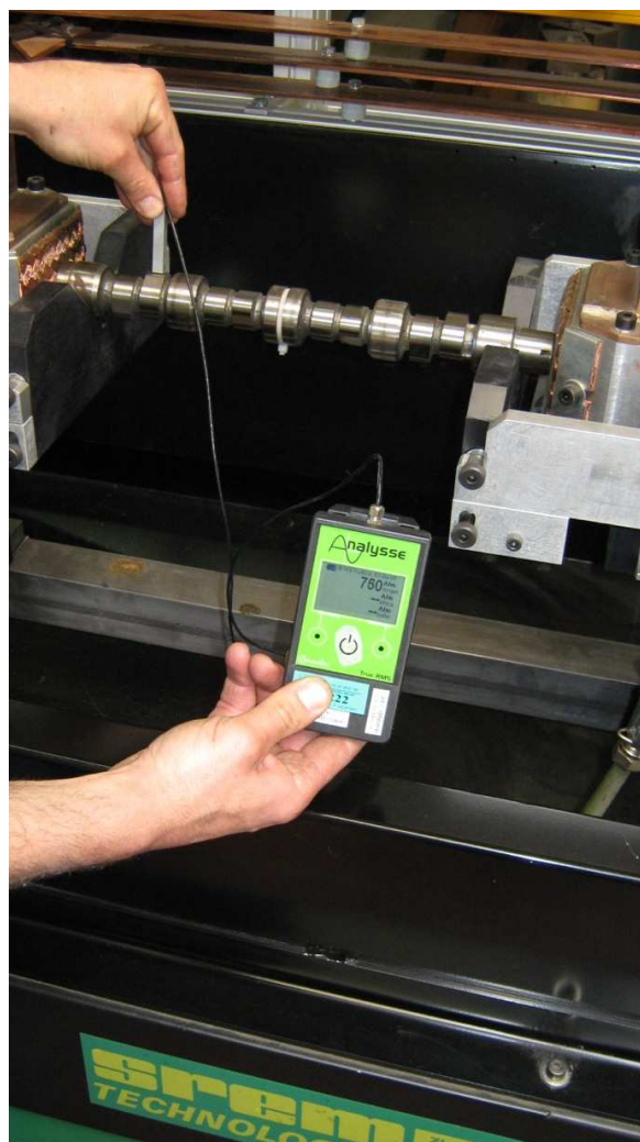
Mesureur numérique de champ magnétique tangentiel affichant simultanément les valeurs : moyenne, crête vraie et efficace vraie
