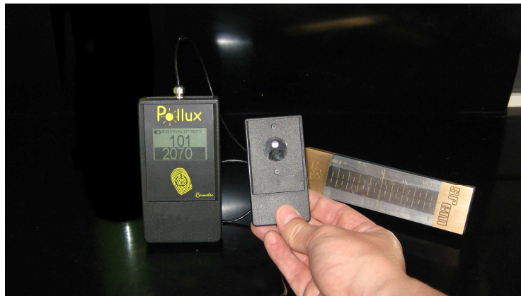
Radiomètre/luxmètre numérique affichant simultanément les valeurs de l'éclairage lumineux et de l'éclairage énergétique (UV-A).
