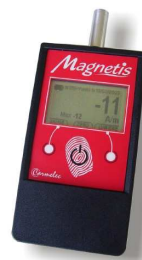
Mesureur numérique soit d'aimantation rémanente, soit de champ magnétique rémanent
